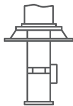
Тип 3 с клапаном и площадкой под исполнительный механизм
