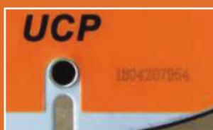
На каждом этапе производства осуществляется инструментальный контроль качества всех компонентов и узлов. Каждый привод имеет индивидуальный серийный номер. В случае обнаружения проблем с электроприводом по этому серийному номеру мы можем отследить все компоненты и протоколы тестирования и оперативно принять решение по согласованию гарантии
