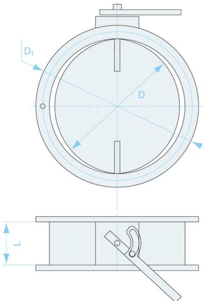
Заслонка предназначена для регулирования количества воздуха и взрывоопасных воздушных смесей в вентиляционных системах взрывоопасных производств. Изготовлена из черной стали.
