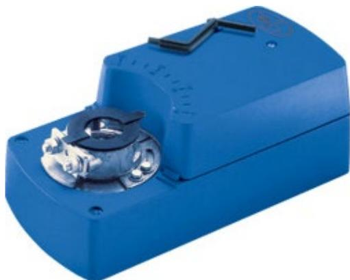
Электрические приводы Polar Bear разработаны специально для использования с воздушными заслонками в системах вентиляции и кондиционирования. В каждый привод встроена система "Safety" с возвратной пружиной, обеспечивающая при аварийном отключении напряжения полное закрытие воздушной заслонки для предотвращения размораживания водяных теплообменников.
