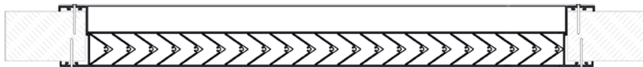
Монтаж переточных решеток РП
