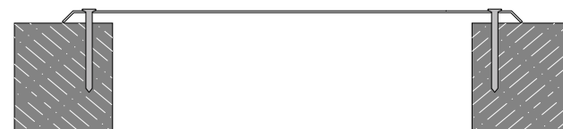
Монтаж перфорированных решеток ВРП-Д
