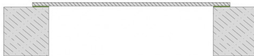
Скрытое крепление с помощью каучукового клея
