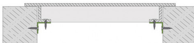
Скрытое крепление с помощью монтажного уголка (МУ)
