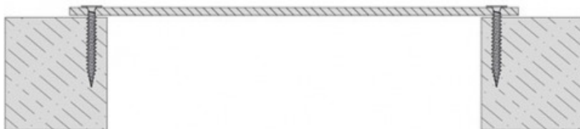
Открытое крепление с помощью саморезов
