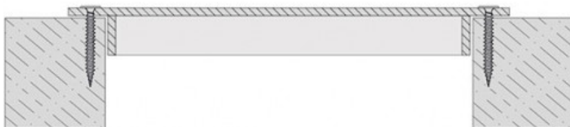
Открытое крепление с помощью саморезов
