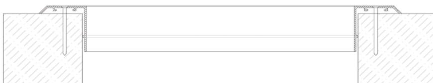
Габаритно-посадочные размеры регулируемой решетки SAG-C+R
