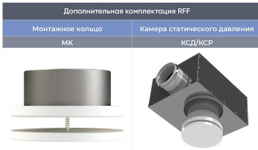
Диффузор RFF устанавливается непосредственно в воздуховод с помощью монтажного кольца с фиксацией распорными пружинами. Если RFF крепится к камере статического давления, то длина прямого воздуховода до камеры статического давления должна составлять не менее 4-х диаметров воздуховода.
